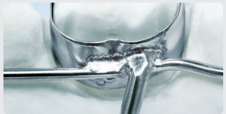
Abb. 2 Typisch für die Laserschweißtechnik: Die „Schweißbraune“.
