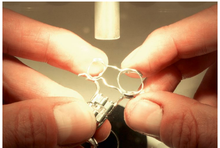
◉ Verschweißen der Drahtbügel und der Arme von unten
