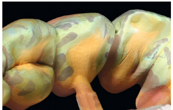
► 12 Kolorieren eines weißen Zirkonoxids durch die sogenannte Aquarelltechnik
