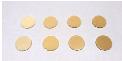
► 13b und ► 13c Muster der Verblendkeramik und gefärbter Zirkonoxide, die zur Optimierung der Farbtöne zwischen cera-Motion Zr und dem Zirkonoxid Nacera verwendet worden sind
