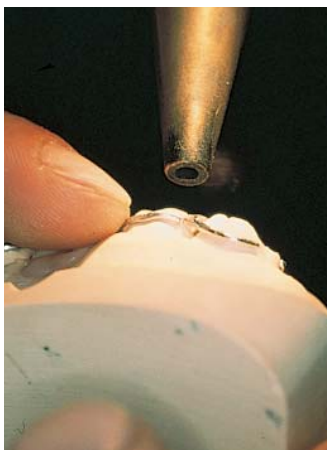
Abb. 7 Schweißkammer mit richtig positionierter Argondüse
