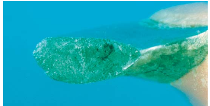
Abb. 2 Karbidausscheidungen an einem Bügelbruch
