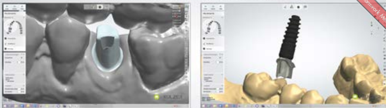
CAD-Konstruktion des Implantataufbaus mit plattformbasierter Anschlussgeometrie
