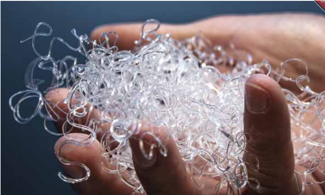
Ein Blick auf die Glasritzen (Zwischenprodukt bei Herstellung von Glasschmelze) zeigt, dass bereits der reine Rohstoff von ceraMotion opaleszente Eigenschaften hat. Ohne Zugabe von blauen oder orangefarbenen Farbstoffen ist die Opaleszenz gegeben. Der Grund sind die Mikrokristalle, durch die Tageslicht spezifisch gestreut und gebeugt wird
