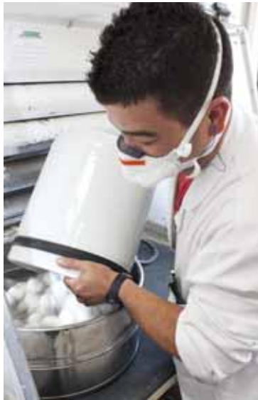
Die reine Glaskeramik wird mit mineralischen Pigmenten versetzt und homogen vermischt. Je nach Anwendung und Korngröße erfolgt dies über verschiedene Verfahren (Luftstrahlmühle, Planetenmühlen et cetera)
