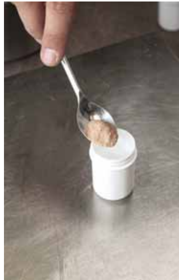
Die reine Glaskeramik wird mit mineralischen Pigmenten versetzt und homogen vermischt. Je nach Anwendung und Korngröße erfolgt dies über verschiedene Verfahren (Luftstrahlmühle, Planetenmühlen et cetera)
