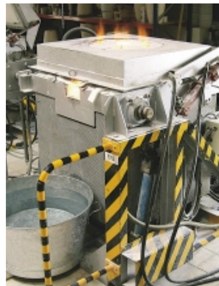
Abb. 1: Schmelzvorgang im schwenkbaren Hafenofen.
