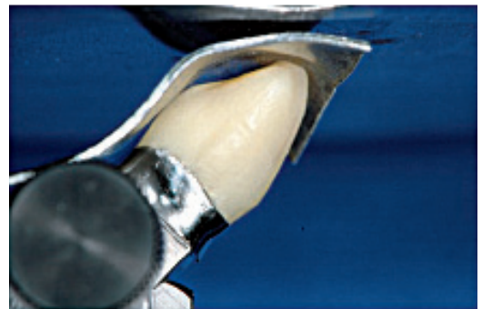
Abb. 12 Prüfanordnung nach Voss zur Bestimmung der Bruchlast.
