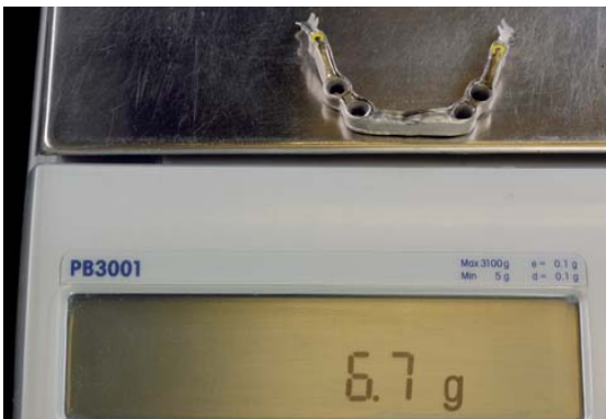
Abb. 31: Stegkonstruktion mit Waage.
