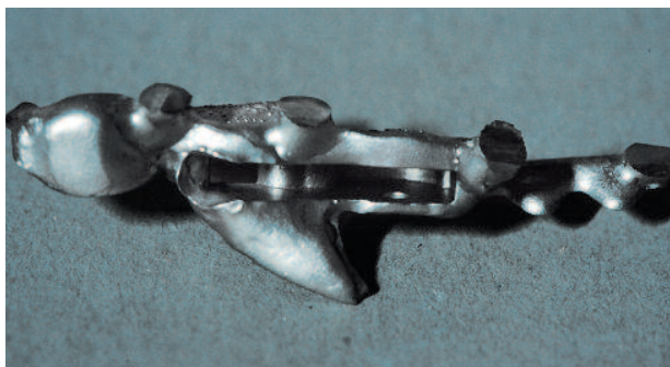
Abb. 23: Ein Blick in das Riegelgehäuse nach dem Guss mit remanium® star.
