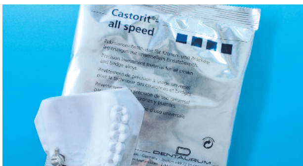
Abb. 19: Die Wachsmodellierung wurde für den Guss der Kronen mit Castorit® all speed eingebettet. Diese K+B Einbettmasse ist mit einer Gesamtexpansion von 3.3% für den Guss von CoCr Legierungen und bei entsprechender Konzentration auch für Edelmetalle geeignet.
