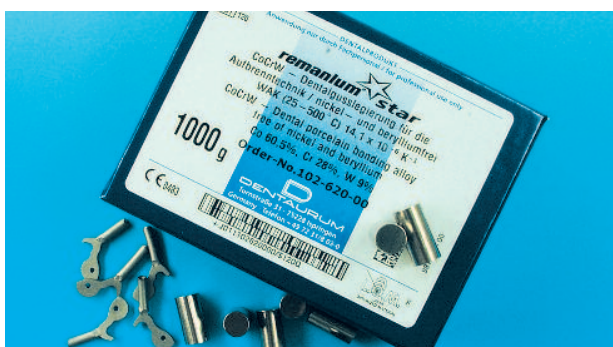
Abb. 11: Die Riegel werden aus einer CoCr Legierung gegossen (remanium® star; Dentaureum) mit einer niedrigen Vickershärte von HV 280. Aus wirtschaftlicher Sicht können in einem Labor CoCr-Riegel in verschiedenen Größen bereits vorgefertigt werden. Wer käme auf die Idee, Goldriegel in der Schublade aufzubewahren?
