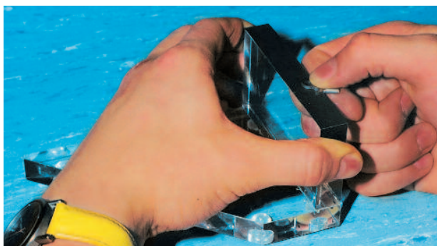
Abb. 13: Die Handhabung der Riegelabziehvorrichtung. Die Oberfläche wird mit Schleifpapier bearbeitet (Korngröße 240, 500 und 1200).
