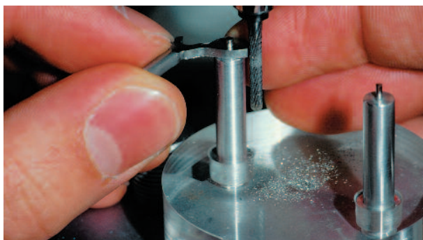
Abb. 14: Das Fräsen des CoCr Riegels. Der Riegel wird bei festgestelltem Arm des Fräsgesäßes im Uhrzeigersinn gegen die Fräse gedreht. Nach dem Einsleifen eines Stoppers ist der Riegel fertiggestellt.
