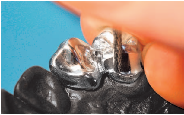
Abb. 10: Fräsung des Umlaufs und der zervikalen Schulter nach dem Guss der Kronen aus remanium® star (Dentaurum).
