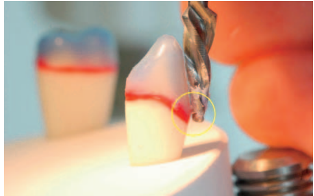
Abb. 16: Nachteil 6-Grad-Fräsung: eventuell sichtbarer Metallrand beim Eckzahnkonus.
