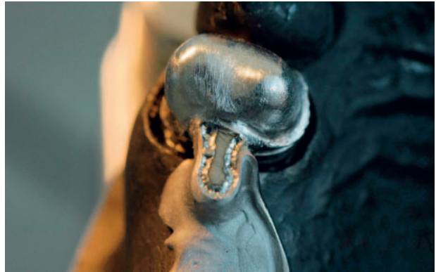
Abb. 24: Schweißverbindung mit Lasertechnik.
