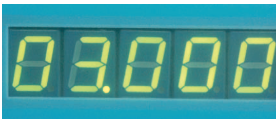
Abb. 8: Drehzahl für die Wachsfräsung: zirka 3.000 Umdrehungen pro Minute.
