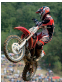
Abb. 1: Teleskoptechnik für Stoßdämpfung (Motorrad) oder ...
