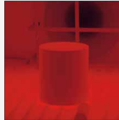
Abb. 11: Muffel im Vorwärmofen
