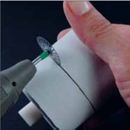
Abb. 15: Eintrennen mit Trennscheibe
