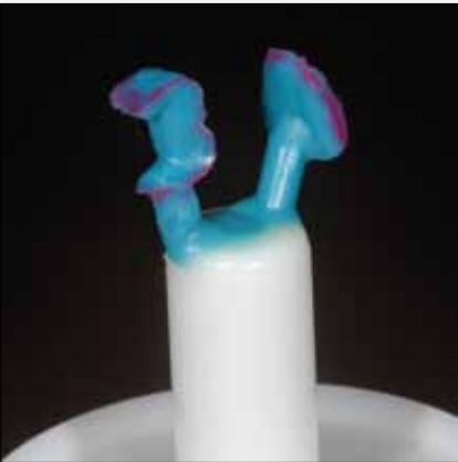
Abb. 6: Anstiftung auf dem Muffelsockel
