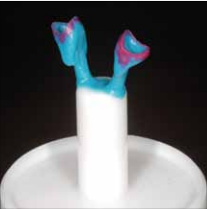
Abb. 5: Anstiftung auf dem Muffelsockel
