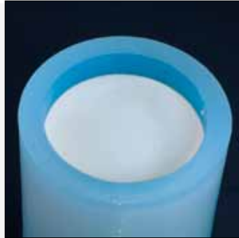
Abb. 7: Einbettmasse aufgefüllt bis zur Markierung
