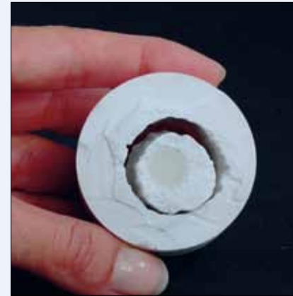
Abb. 24: Ausstrahlen des Innenzylinders
