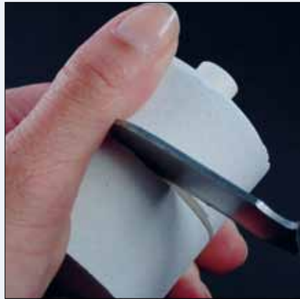
Abb. 22: Auftrennen der Muffel
