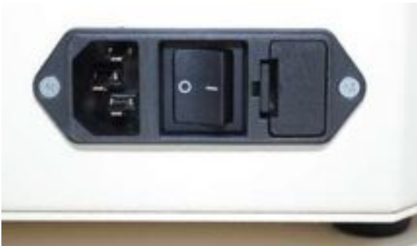
Hauptschalter auf der Geräterückseite
