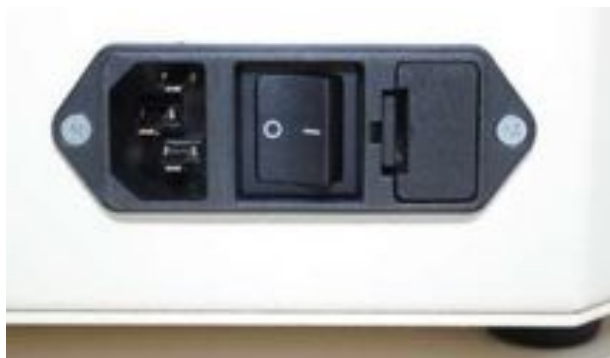
Commutateur principal au dos de l'appareil
