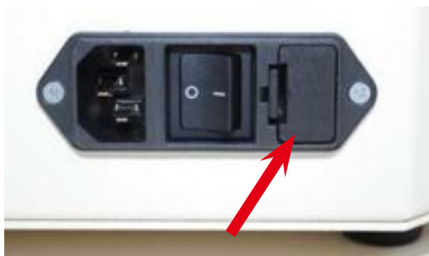
Hauptschalter mit Sicherungshalter auf der Geräterückseite
