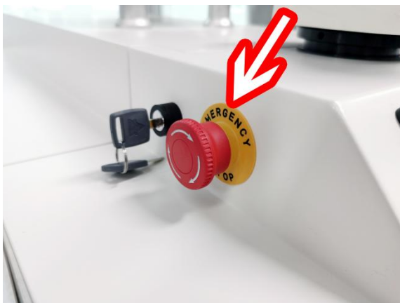
Imagen 1 Parada de emergencia
