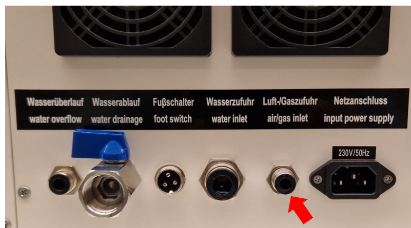
Imagen 13 Conexión de gas
