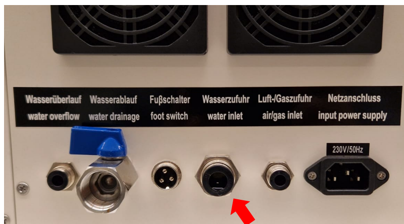
Imagen 11 Entrada de agua
