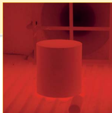
Fig. 1: cilindro e pistone di pressatura nel forno
