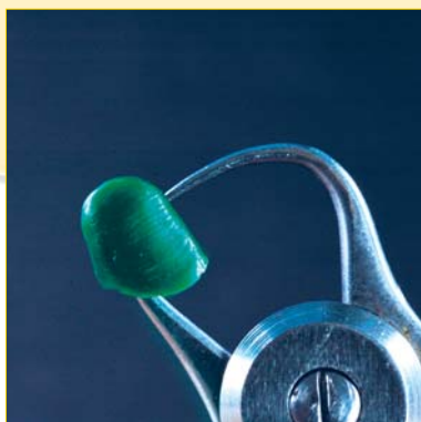
Fig. 4: verifica della modellazione, mai inferiore a 0,8 mm.
