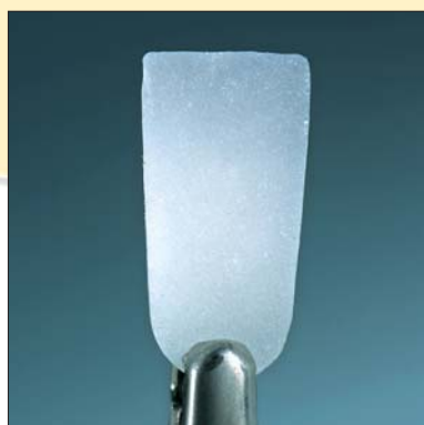
Fig. 2: provino cotto a temperatura troppo bassa
