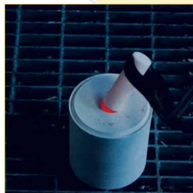
Fig. 3: inserimento del pistone di pressatura
