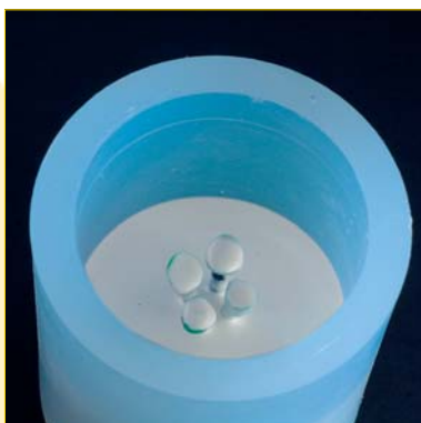
Fig. 6: messa in rivestimento degli elementi fissati
