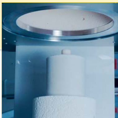
Fig. 5: il cilindro nel forno dopo la pressatura; si noti l'abbassamento del pistone
