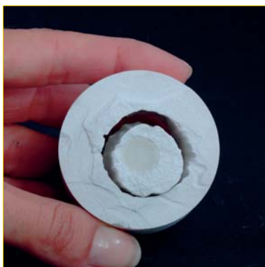
Fig. 5: sabbiatura dell'interno cilindro
