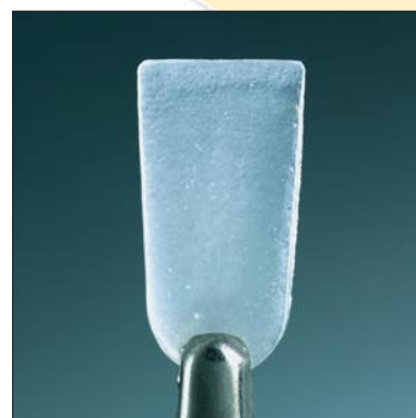
Fig. 1: provino cotto a temperatura corretta
