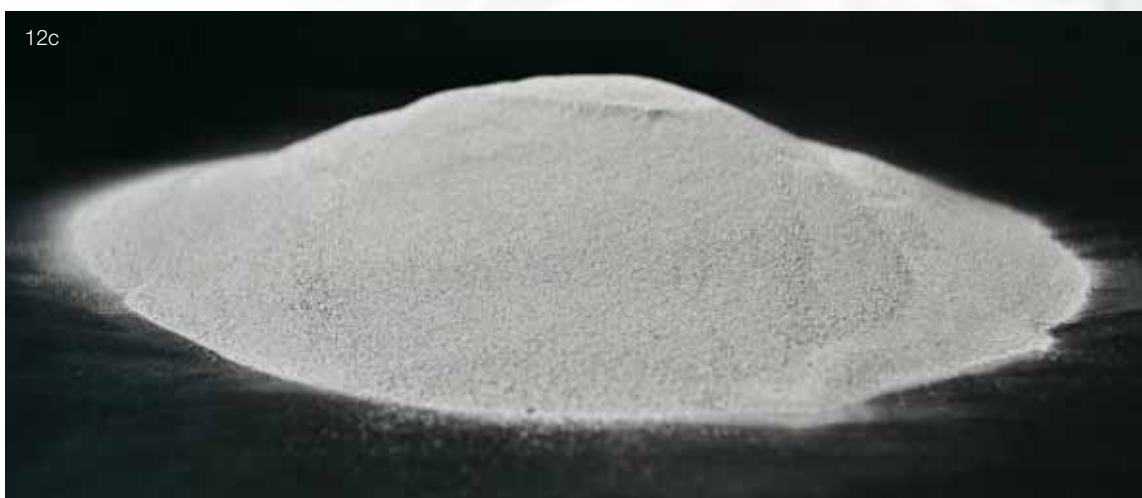
Abb. 12a bis c: Eine Legierung, drei Verarbeitungsvarianten: remanium star als Gusszylinder (a), Fräsrohlinge (b) und Mikro-Pulver für die SLM-Technik (c)
