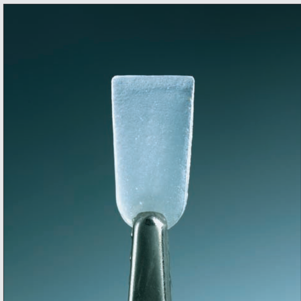
Fig. 1: provino cotto a temperatura ottimale
