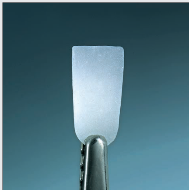
Fig. 2: provino cotto a temperatura più bassa
